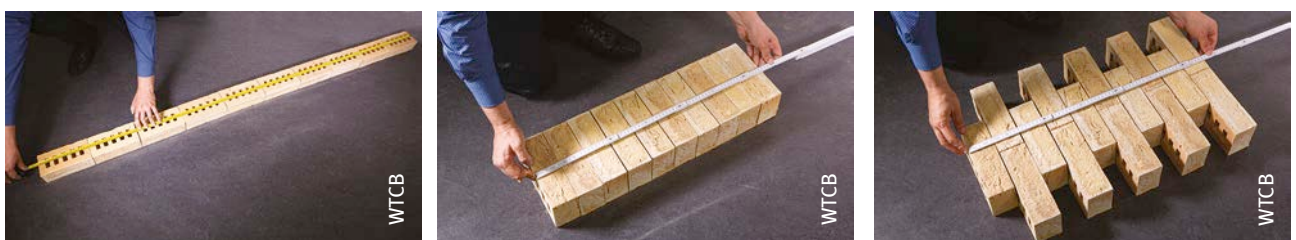
Afb. 54 Bepaling van de modulaire afmetingen.
