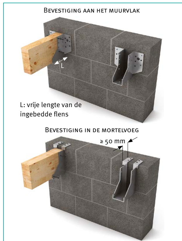
Afb. 26 Voorbeelden van balkschoenen.
