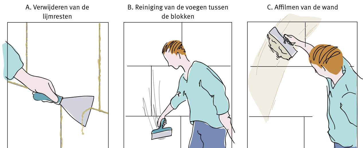
Afb. 60 Uitvoering van een wand uit gipsblokken.
